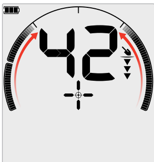
Señal de objetivo débil o des centrada: se activan menos segmentos de discriminación. El objetivo se sitúa más cerca del exterior de la bobina.
